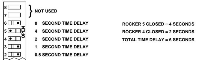
NOTE: THE VALUE OF ROCKERS SET IN THE CLOSED POSITION ARE ADDITIVE A0282
